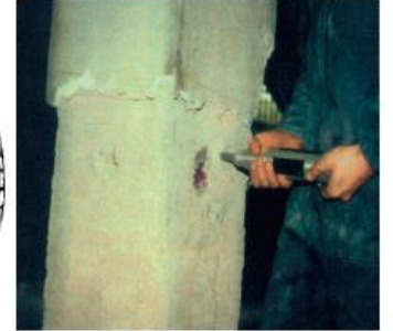
Slika br. 120 Metoda ispitivanja betona sklerometrom (Schmidthov čekić)
